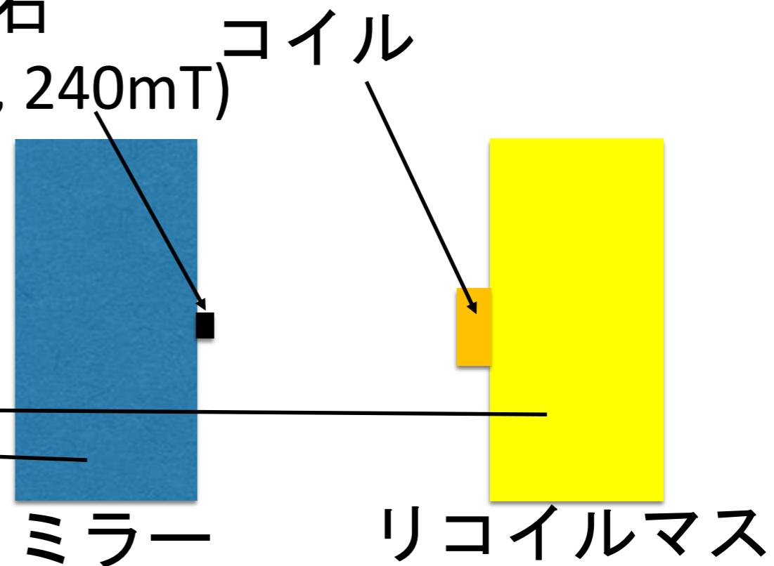
コイルに電流を流し、ミラーに取り付けた磁石に力を加えることでミラーを動かしてミラー位置を制御。
