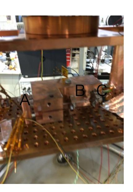
クランプを変更し、 fiberとヒートシンクの接触面積を増加。
