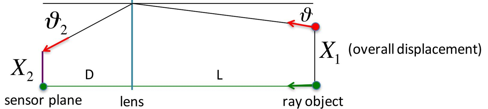
$$\begin{pmatrix} X_2 \\ \vartheta_2 \end{pmatrix} = \begin{pmatrix} 1 & D \\ 0 & 1 \end{pmatrix} \begin{pmatrix} 1 & 0 \\ -\frac{1}{f} & 1 \end{pmatrix} \begin{pmatrix} 1 & L \\ 0 & 1 \end{pmatrix} \begin{pmatrix} X_1 \\ \vartheta \end{pmatrix}$$
