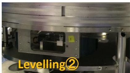
IPが倒れないように調整することができた後は、Stepping motor slider で微調整を行う。Feedback をかけたときに、大きく押し返されない位置に動かすことが目標。(その近づきたい位置は、主に干渉計としての鏡の位置によって設定。)
