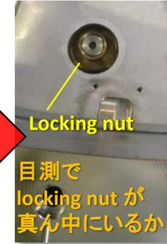
この段階で主に行うことは、IPの足の下のcupの高さ(IP base frameの傾き)調整。
