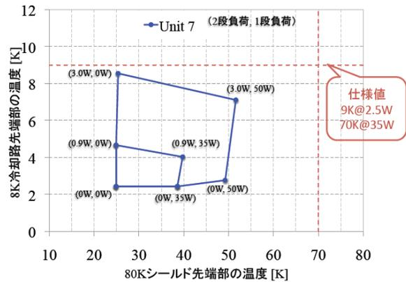
Load map of cryocooler. (C.Tokoku, 2012 Nov. CSJ)
