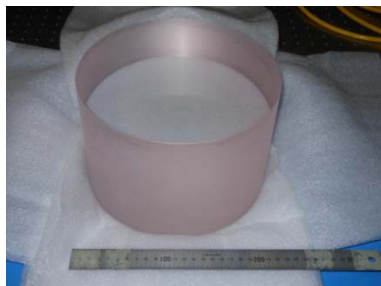
直径22cm 厚さ15cm C軸結晶
