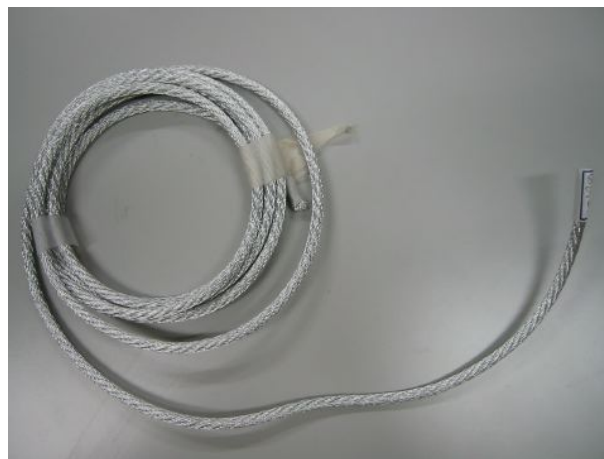
図 11.7: 大きな熱輸送力を持つ柔軟な伝熱ケーブル。撚り合わせた純 Al 細線で構成される。
