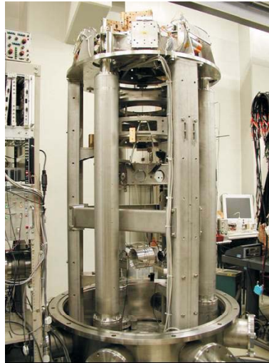
図 13.4: 3m Fabry-Perot 実験に用いられた TAMA SAS 試作機。
