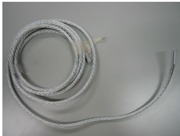
図 11.7: 大きな熱輸送力を持つ柔軟な伝熱ケーブル。撚り合わせた純 Al 細線で構成される。
