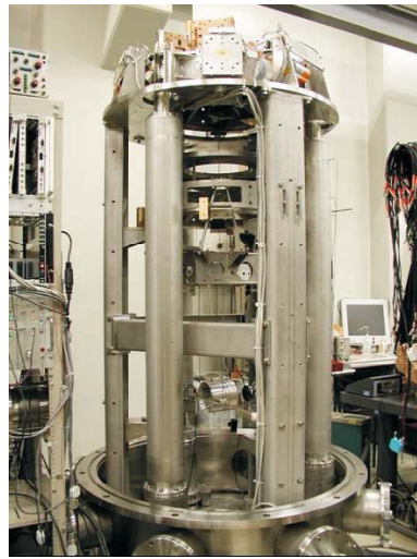
図 12.4: 3m Fabry-Perot 実験に用いられた TAMA SAS 試作機。
